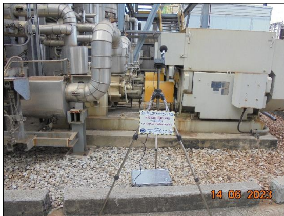
รูปที่ 3.6 การตรวจวัดระดับเสียงในพื้นที่ทำงาน บริเวณ Boiler Feed Pump
