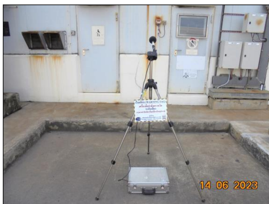
รูปที่ 3.4 การตรวจวัดระดับเสียงในพื้นที่ทำงาน บริเวณ Gas Turbine 3 – North
