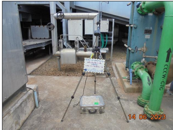
รูปที่ 3.2 การตรวจวัดระดับเสียงในพื้นที่ทำงาน บริเวณ HRSG 3 – West
