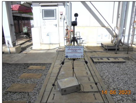
รูปที่ 3.5 การตรวจวัดระดับเสียงในพื้นที่ทำงาน บริเวณ Gas Turbine 3 - South
