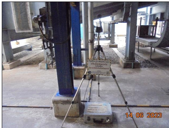
รูปที่ 3.3 การตรวจวัดระดับเสียงในพื้นที่ทำงาน บริเวณ HRSG 3 - East
