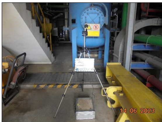
รูปที่ 3.7 การตรวจวัดระดับเสียงในพื้นที่ทำงาน บริเวณ Steam Turbine
